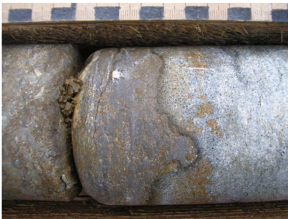
Joonis 2.3. Sillaoru ja Toila kihistu piiri markeerib katkestuspind.
