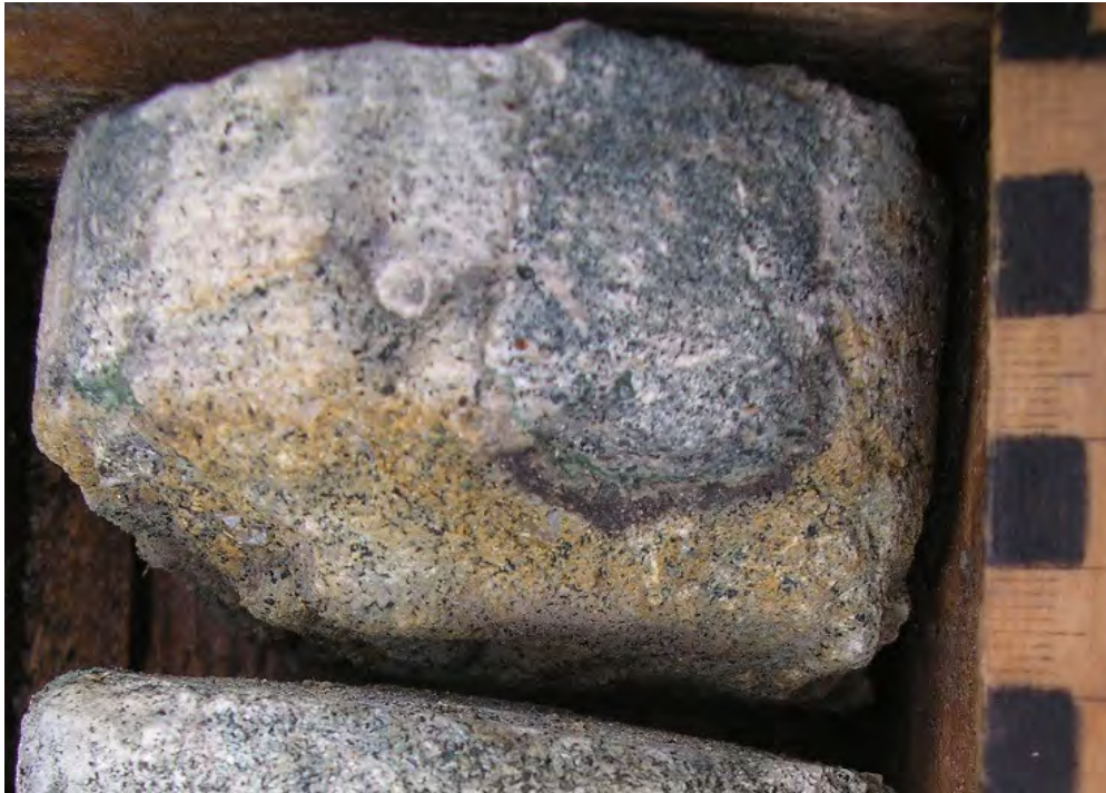
Joonis 2.6. Püstakkiht, mis markeerib Volhovi lademe alumist piiri.
