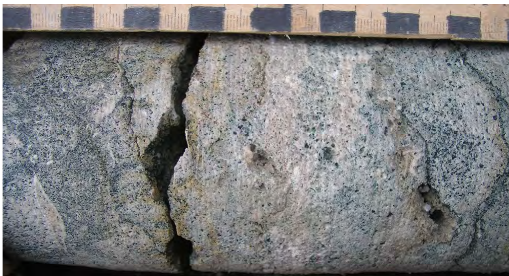
Joonis 2.5. Toila kihistu alumise osa moodustab suurte glaukoniiditeradega dolomiidistunud lubjakivi.
