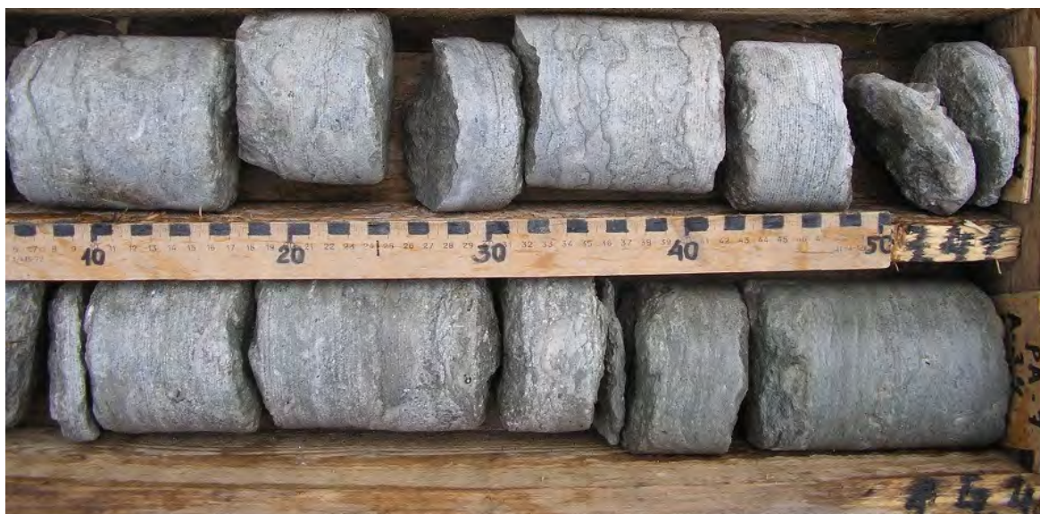
Joonis 2.1. Loobu kihistu ülemise poole moodustab rohkete katkestuspindadega lubjakivi ja allosa tumedam hall dolomiidistunud lubjakivi.
